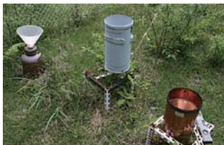
降水量の測定のための雨量計(中央: 転倒マス式、右: 貯留式)と降水試料を採取するためのボトル(左)(東京大学千葉演習林)。
