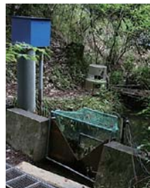
集水域からの流出量を観測するための量水堰。様々な溶存物質の濃度を測定するために水試料が採取されます(中央奥の装置が自動採水器)(東京大学千葉演習林)。
