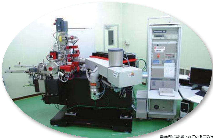
農学部に設置されている二次元高分解能SIMS (NanoSIMS 50L, Cameca社製)
