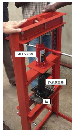
図2. 電気を使わない、搾油およびブリケット製造器 搾油成型器に砕いて加熱した実を入れ、加圧することで油を絞る。また搾油成型器を加熱して再び加圧することで、毒性のないブリケットを作成可能。油は石油と混ぜてランプの燃料としたり、バイオディーゼルの燃料として発電機に使用する。
