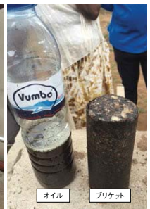
図2. 電気を使わない、搾油およびブリケット製造器 搾油成型器に砕いて加熱した実を入れ、加圧することで油を絞る。また搾油成型器を加熱して再び加圧することで、毒性のないブリケットを作成可能。油は石油と混ぜてランプの燃料としたり、バイオディーゼルの燃料として発電機に使用する。
