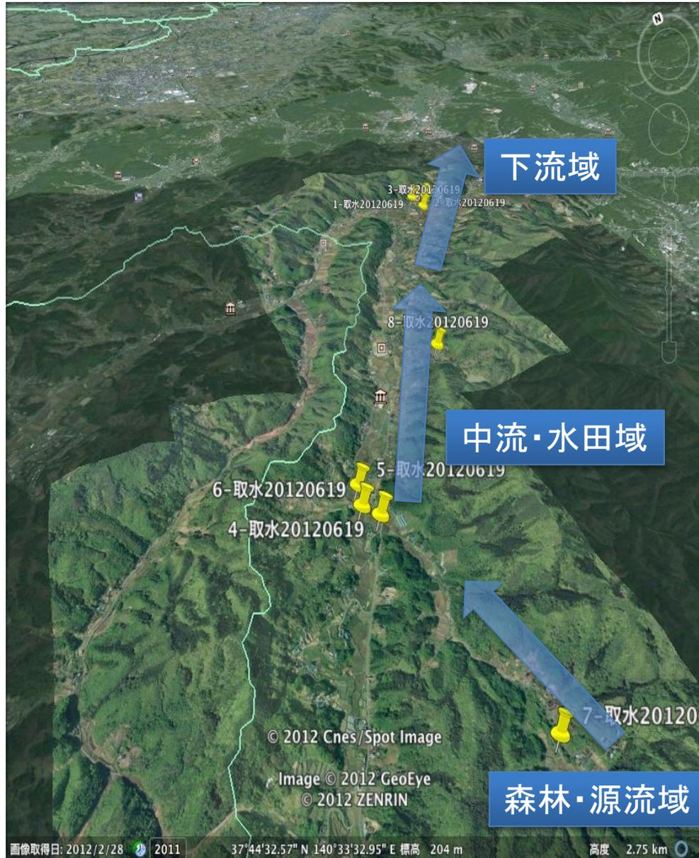
図-1  $^{137}\text{Cs}$ の収支を評価するコンパートメント。
