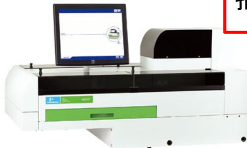
NaIシンチレーションカウンターにて放射性Cs濃度を測定
