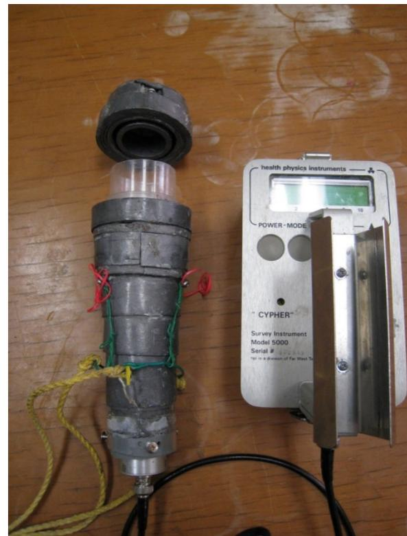
シンチレーションサーベイメータにコリメータを付け、土中の塩ビパイプ内で、水平方向に入射するガンマ線量を測定する:
