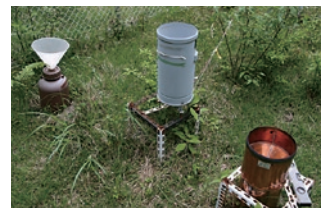
降水量の測定のための雨量計（中央：転倒マス式、右：貯留式）と降水試料を採取するためのボウル（左）（東京大学千葉演習林）。
