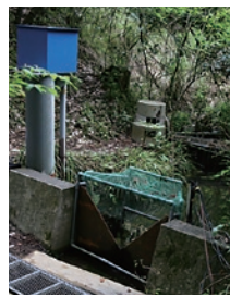
集水域からの流出量を観測するための量水堰。様々な溶存物質の濃度を測定するために水試料が採取されます（中央奥の装置が自動採水器）（東京大学千葉演習林）。
