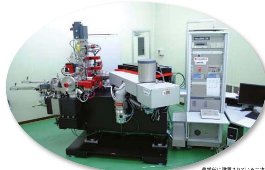
農学部設置されている二次元高分解能SIMS (NanoSIMS 50L, Cameca社製)
