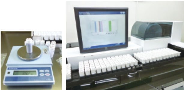
図2. 土壌中の放射能を測定するNaIシンチレーションカウンター 土壌中の放射性セシウム137の濃度は、放射性セシウムが壊変するときに放出するガンマ線と呼ばれる放射線の強さを測定するとわかります。放射線が当たると蛍光を発生するヨウ化ナトリウムシンチレータを利用して検出しています。
