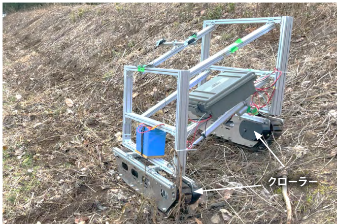
変形機構を備えた草刈りロボット 車体が、斜面の傾きにに合わせて変形し、左右クローラー(キャタピラ)にかかる荷重が均等になるように制御されます。これにより、斜面を滑らずにまっすぐ横切ることができます。
