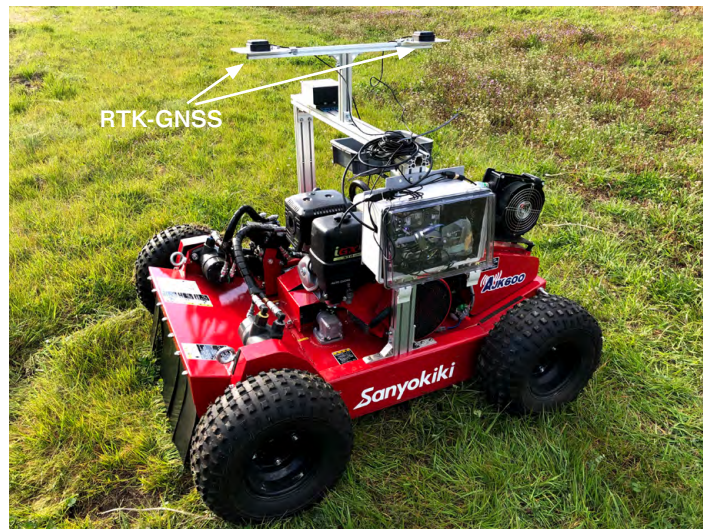
RTK-GNSSによって制御されるロボット草刈り機 アンテナを2台つけることによって、位置だけではなく、方向も正確に計測することができます。四輪駆動で急な坂道も上り下りできます。
