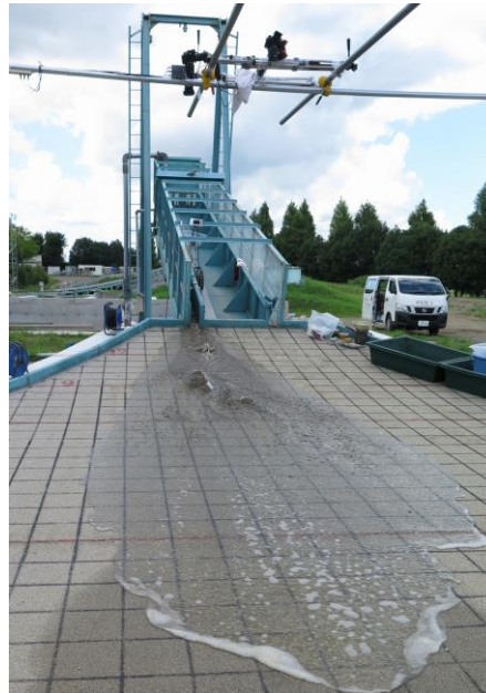
土石流の水路実験：流下・堆積の実態解明や、モデル化・数値計算の検証に。
