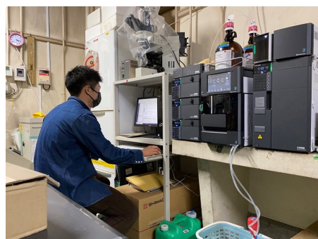
高速液体クロマトグラフで光合成色素組成を分析します
