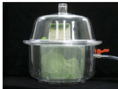
減圧浸潤法によるベンサミアナタバコ地上部への外来遺伝子の導入
