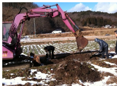
写真-1 飯舘村佐須字滑の水田における凍土剥ぎ取り実証実験 (2012年1月8日)
