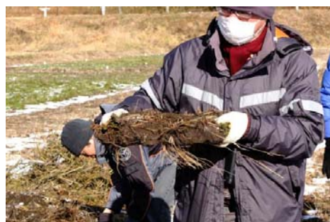
写真-2 板状の塊のまま剥ぎ取られた厚さ 5cm の凍土
