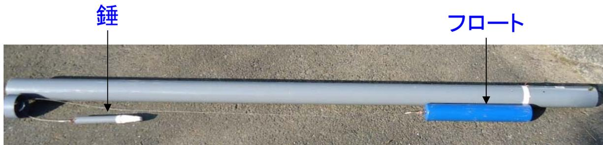
渓流水位が上昇するとフロートが浮き、錘がワイヤーを引く
