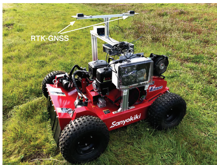
RTK-GNSSによって制御されるロボット草刈り機
